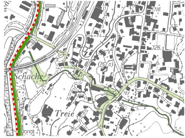
Abb. 12: Intensitätskarte HQ100, Grabenlochbach Abs. 3
